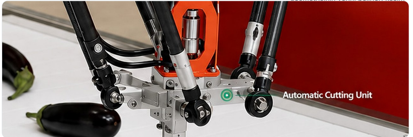
ÜRÜN KONVEYÖRÜ ÜZERİNDEKİ GÖRÜŞ VE KESİM BÖLGESİ
