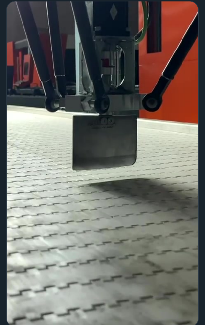
DELTA BAĞLANTISI ÜZERİNDEKİ KESME ÜNİTESİ
